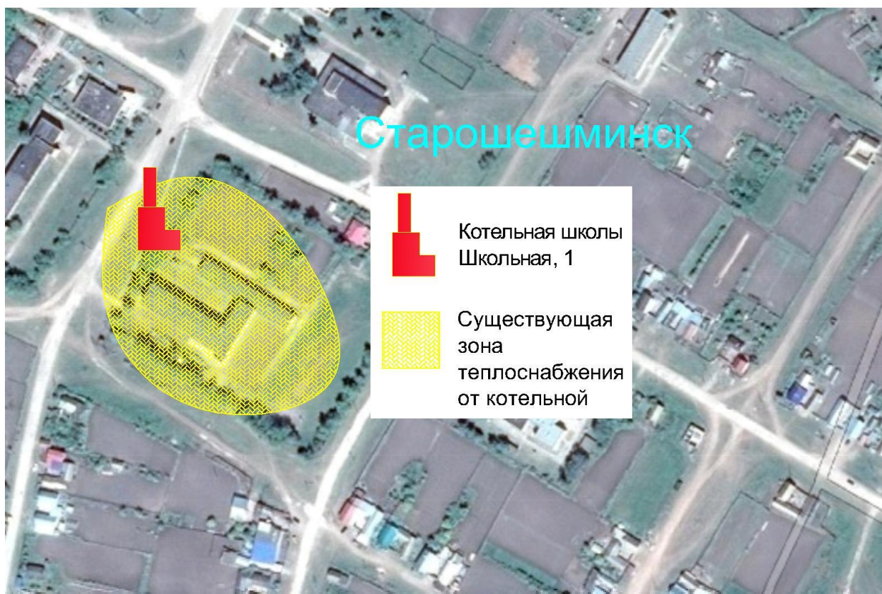
Рисунок 2-1. Существующая зона действия котельной МБОУ «Старошешминская СОШ»
